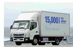
La giapponese Fuso, del Gruppo Daimler, ha in listino il Canter Eco Hybrid, un autocarro con massa complessiva da 3,5 a 8,55 tonnellate che utilizza la trasmissione ibrida diesel-elettrica,...
